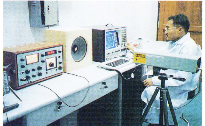
ระบบ The laser Velocity Transducer Set Type 3544 สำหรับการวัด การสั่นสะเทือนเพื่อตรวจสอบ diaphragm
