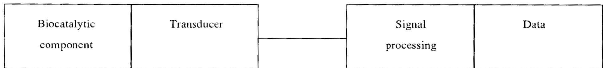
รูปที่ 1 โครงสร้างและหลักการทำงานของไบโอเซนเซอร์
