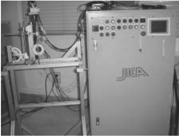
รูปที่ 1 ระบบอัตโนมัติสำหรับสอบเทียบเทอร์โมมิเตอร์แบบหลอดแก้ว
