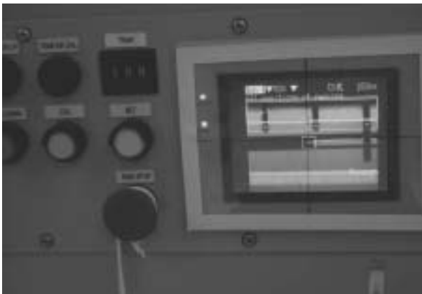
รูปที่ 3 จอภาพแสดงระดับปรอทและขีดสเกลบนเทอร์โมมิเตอร์แบบหลอดแก้วที่กำลังสอบเทียบ
