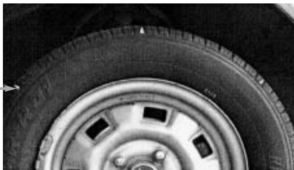
รูปที่ 1 ตำแหน่งบอกการสึกของดอกยาง
