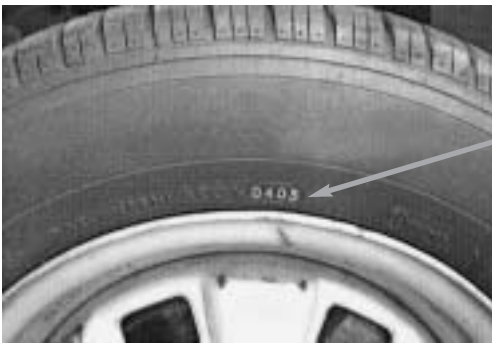
รูปที่ 4 ตำแหน่งบอกสัปดาห์และปีที่ผลิต
