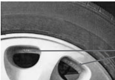
รูปที่ 3 ตำแหน่งบอกขนาดของกระทะล้อ
