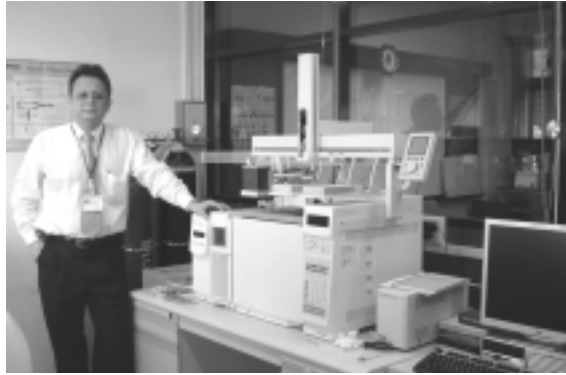
เครื่อง Gas Chromatography Mass Spectrometry สำหรับแยกและวิเคราะห์สารประกอบอินทรีย์
