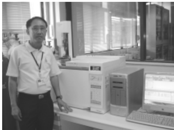
เครื่องทดสอบกรดอะมิโนแบบอัตโนมัติ เพื่อทดสอบชนิดและปริมาณกรดอะมิโนในอาหาร
