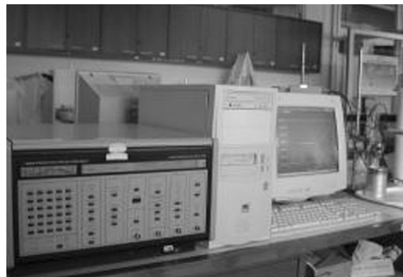
ภาพที่ 3 แสดงการทดสอบการหาอัตราการกัดกร่อนของน้ำส้มประดกระป๋องในห้องปฏิบัติการโดยเครื่อง Potentiostat / Galvanostat
