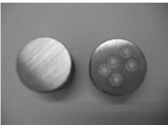
ภาพที่ 4 แสดงตัวอย่างก่อนเหล็กก่อนและหลังการทดสอบด้วยสปาร์กอิมิสชันสเปกโทรมิเตอร์
