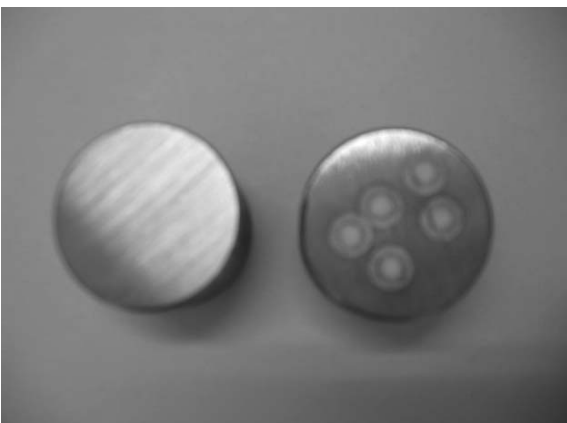
ภาพที่ 4 แสดงตัวอย่างก่อนเหล็กก่อนและหลังการทดสอบด้วยสปาร์กอิมิตชันสเปกโทรมิเตอร์
