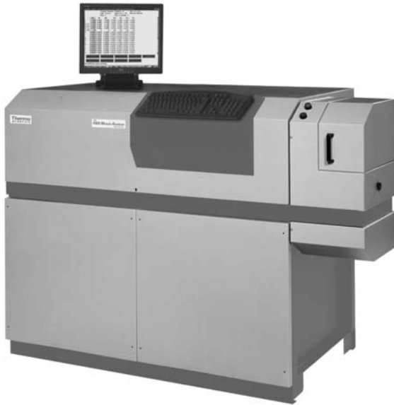
ภาพที่ 2 เครื่องสปาร์กอิมิตชันสเปกโทรมิเตอร์ รุ่น ARL 4460 (บริษัท ARL Applied Research Laboratories S.A.)
