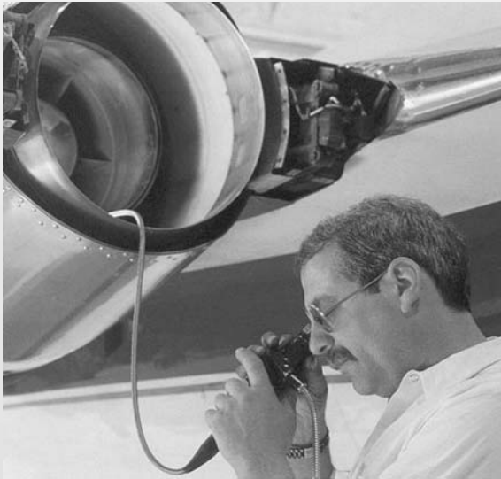
ภาพที่ 1 การตรวจสอบชิ้นส่วนเครื่องยนต์เครื่องบินโดยใช้บอร์สโคป (ที่มา : www.ndt-ed.org )
