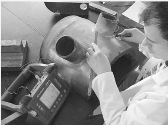
ภาพที่ 6 การตรวจสอบรอยบกพร่องโดยใช้คลื่นความถี่สูง ( http://veli.adit.fr )
