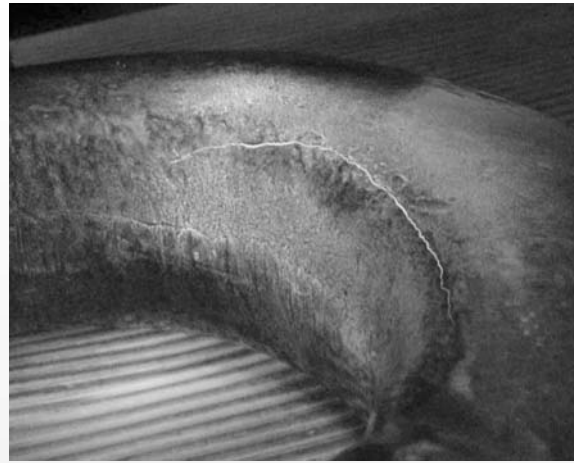
ภาพที่ 4 ตัวอย่างการตรวจสอบโดยใช้ผงแม่เหล็ก (ที่มา : www.ndt-ed.org )
