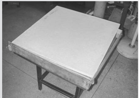
แผ่นยิปซัมเสริมเส้นใยธรรมชาติจากหญ้าแฝก ขนาด 600 x 600 x 9 มิลลิเมตร
