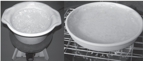
ภาพที่ 5 การทดสอบผลิตภัณฑ์โดยตั้งบนเตาไฟฟ้าและเตาแก๊สขณะน้ำเดือด
