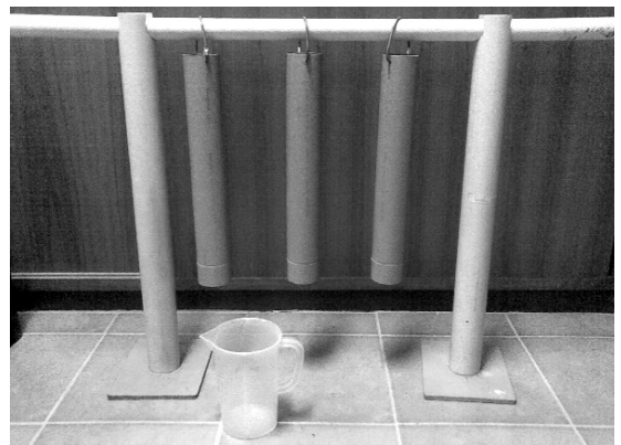
ภาพที่ 2 แสดงเครื่องมือที่ใช้ในการทดสอบรั่วซึมถุงมือยางในปัจจุบัน
