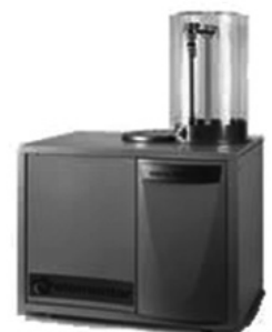
ภาพที่ 2: ตัวอย่างเครื่อง Dumas combustion
