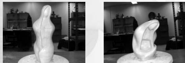
5. การทำแบบพิมพ์ปูนปลาสเตอร์สำหรับหล่อสลิป ทาสูญญากาศประมาณ 4-5 ครั้ง จนมั่นใจได้ว่าเมื่อทำน้ำมันพิชบางๆ อีกครั้งและเทปูนปลาสเตอร์ทับบนต้นแบบปูนปลาสเตอร์จะไม่สามารถแตกติดพิวได้ (ดูภาพที่ 10)
