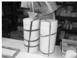
6. การหล่อน้ำสลิปในแบบพิมพ์ปูนปลาสเตอร์ โดยทำความสะอาดการเขี้ดปัดเปล่าผู้นละเออะองออกให้หมด ถ้าหากมีเศษ ผู้นละเออะองกันระหว่างพิมพ์ จะทำให้เกิดตะเข็บใหญ่เป็นตำแหน่งขึ้นงานที่หล่อสลิปได้ ประกอบพิมพ์เข้าด้วยกันรัดแบบพิมพ์ให้แน่น
