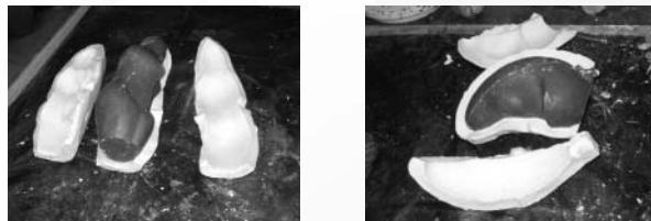
3.4 แกะพิมพ์ออกจากกัน ใช้ปลายมีดแกะพิมพ์ 1, 2 และ 3 ออกจากต้นแบบตามรอยต่อแต่ละชั้นทุกๆ ชั้น จะได้พิมพ์ทุบตามต้องการ (ดูภาพที่ 5)
