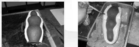
3.3 ทำพิมพ์ชั้นที่ 2 และ 3 โดยท่าน้ำสบู่และน้ำมันพีช (ด้านข้างพิมพ์) ตามแนวรอยต่อเพื่อเทพิมพ์ชั้นที่ 2 และ 3 เพื่อป้องกันพิมพ์ 1, 2 และ 3 ไม่ให้เข้มิดกัน (ดูภาพที่ 4)
