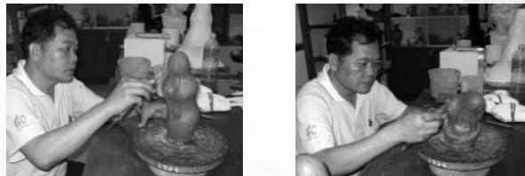
2. การปั้นต้นแบบ ใช้ดินเหนียวหรือดินน้ำมันปั้นขึ้นรูปตามแบบ โดยขยายสัดส่วนเพื่อการหดตัวตามร้อยละในการหดตัว ของเนื้อดินที่จะใช้ในการหล่อขึ้นรูปผลิตภัณฑ์ (ดูภาพที่ 1)
