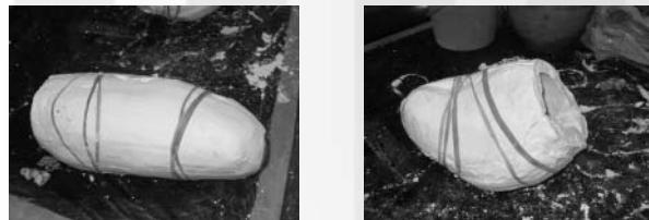
3.6 ประกบแบบพิมพ์เข้าด้วยกันให้สนิท รัดแบบพิมพ์ด้วยยางรัดแบบ ผสมปูนปลาสเตอร์ที่ใช้สัดส่วนสำหรับทำต้นแบบ เทลงในแบบพิมพ์จนเต็ม แกะพิมพ์ทุกชิ้นออก (ดูภาพที่ 7) จะได้งานต้นแบบปูนปลาสเตอร์ตามต้องการ ตกแต่งขัดพื้นผิวด้านแบบให้เรียบเนียน ได้งานต้นแบบปูนปลาสเตอร์พร้อมทำแบบพิมพ์สำหรับหล่อสลิป (ดูภาพที่ 8)
