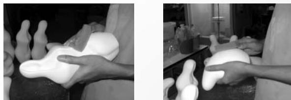
9.1 เช็ดทำความสะอาดผลิตภัณฑ์ก่อนทำการเคลือบ (ดูภาพที่ 20)
