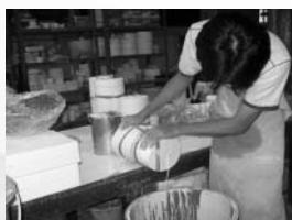
6.2 เทน้ำดินออกจากแบบพิมพ์ ตะแคงแบบพิมพ์เทน้ำสลิปออกให้หมด ควรพิมพ์ไว้ประมาณ 30นาที เพื่อให้เนื้อดินแห้งแข็งตัว จากนั้นพากายแบบพิมพ์ขึ้นปล่อยทิ้งไว้อีก 30 นาที (ดูภาพที่ 16)
