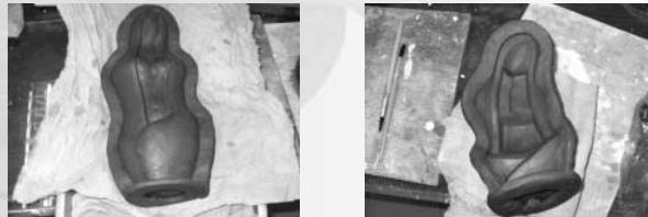
3.1 การก้นพิมพ์ขึ้นแรก ใช้ดินเหนียวหรือดินน้ำมันเคลือบเป็นเส้นยาวทุบเส้นให้แบบมีความหนาพอสมควร ก้นตามแนว ที่แบ่งไว้ (ดูภาพที่ 2)
