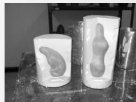
ภาพที่ 13 แสดงการทำพิมพ์สำหรับหล่อสลัก
