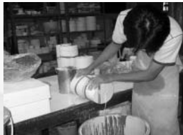
ภาพที่ 16 แสดงการเทน้ำสลิบออกจากแบบพิมพ์
