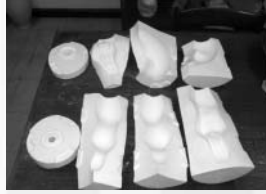
ภาพที่ 14 แสดงแบบพิมพ์ที่พร้อมใช้หล่อสลิบ
