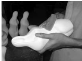
ภาพที่ 20 แสดงการทำความสะอาดผลิตภัณฑ์ดิบ
