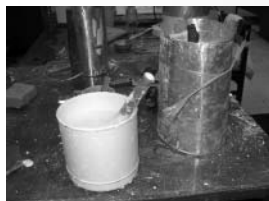
ภาพที่ 13 แสดงการทำพิมพ์สำหรับหล่อสลัก
