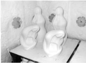
ภาพที่ 19 แสดงภายในเตาเผาขณะทำการเผาดิบ
