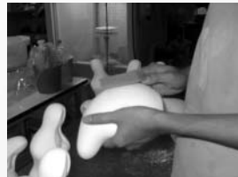
ภาพที่ 20 แสดงการทำความสะอาดผลิตภัณฑ์ดิบ
