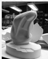
ภาพที่ 17 ภาพแสดงการแกะพิมพ์ออกจากชิ้นงาน
