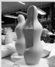
ภาพที่ 17 ภาพแสดงการแกะพิมพ์ออกจากชิ้นงาน
