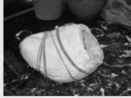
ภาพที่ 7 แสดงการประกอบพิมพ์และการเทปูนพลาสติก
