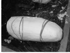
ภาพที่ 7 แสดงการประกอบพิมพ์และการเทปูนพลาสติก
