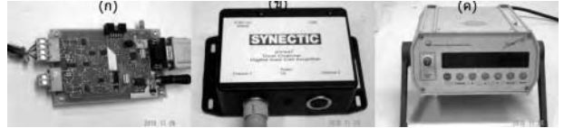
ภาพที่ 3 : อุปกรณ์อ่านค่าแรง ก) DSS LCA1 ข) SY047 ค) SCOUT55
