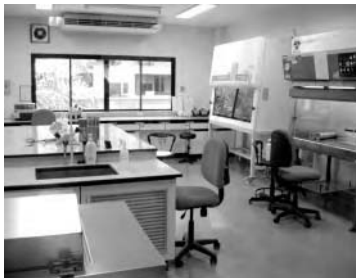
ภาพที่ 2 แสดงการแยกพื้นที่โต๊ะปฏิบัติการและบริเวณตู้ปลอดเชื้อสำหรับปฏิบัติงานวิเคราะห์ทดสอบทางจุลชีววิทยาและการจัดให้มีอ่างล้างมืออย่างเป็นสัดส่วน
