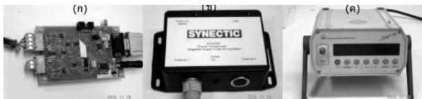
ภาพที่ 3 : อุปกรณ์อ่านค่าแรง ก) DSS LCA1 ข) SY047 ค) SCOUT55
