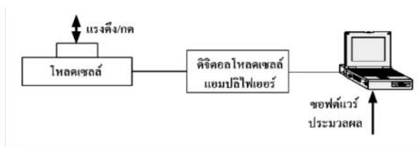
ภาพที่ 1 : การเชื่อมต่อของชุดสอบเทียบด้านแรง
