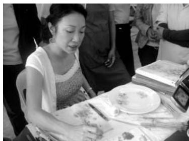
4. ใช้พู่กันแบบที่มีขนาดพอเหมาะสมกับลายและน้ำมันพาราฟินและสีที่บดแล้ว วาดบางๆ ลงบนภาชนะโดยลงสีอ่อนซึ่งเป็นพื้นของลายในทุกๆ ส่วนก่อน เช่น สีพื้น ดอก ใบ เพื่อที่จะทำได้โดยจะต้องไม่วัดทับกัน
