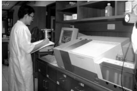
ภาพที่ 2 เครื่องทดสอบหาค่าสารประกอบ Organically bound chlorine
