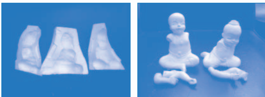
ภาพที่ 9 ลักษณะแบบพิมพ์ทาบ ภาพที่ 10 ต้นแบบตุ๊กตาปูนปลาสเตอร์ที่หล่อจากแบบพิมพ์ทาบ
