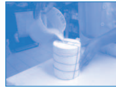
ภาพที่ 15 การหล่อน้ำดินในแบบพิมพ์แขน
