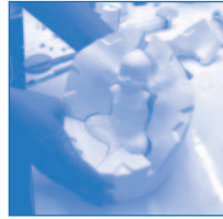
ภาพที่ 11 แสดงการทำแบบพิมพ์ ภาพที่ 12 แบบพิมพ์หล่อน้ำดินพร้อมใช้งาน
