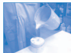
ภาพที่ 15 การหล่อน้ำดินในแบบพิมพ์แขน
