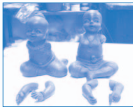
ภาพที่ 9 ลักษณะแบบพิมพ์ทาบ ภาพที่ 10 ต้นแบบตุ๊กตาปูนปลาสเตอร์ที่หล่อจากแบบพิมพ์ทาบ
