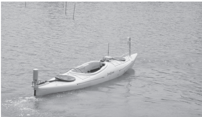
ภาพแสดงเรือหุ่นยนต์เคลื่อนที่ในแบบอัตโนมัติควบคุมด้วยพิกัด GPS กำลังปฏิบัติการเก็บความลึกของอ่างเก็บน้ำเพื่อประโยชน์ในการหาปริมาณที่แท้จริงของอ่างอย่างแม่นยำในระยะเวลาอันรวดเร็ว
