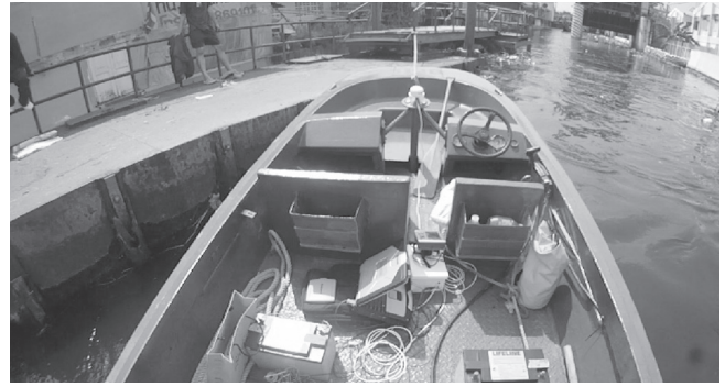
ภาพแสดงระบบเก็บข้อมูลความลึกติดตั้งบนเรือโจมตีขนาดเล็กของกองทัพเรือ
