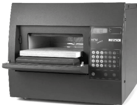
รูปที่ 3 (a) การออกแบบเครื่องมือวัดแบบ Heat Flow Meter, (b) เครื่อง HFM 436/3 Lambda ที่ใช้หลักการแบบ Heat Flow Meter
