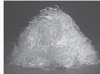
รูปที่ 1 (1) กราฟ TGA แสดงอุณหภูมิการสลายตัว Epoxy-glass fibers (2) Epoxy resin with glass fibers (3) Chopped glass fibers
