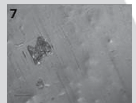
ภาพที่ 4 รอยตำหนิบนผิวขวดแก้วที่นำกลับมาใช้ใหม่ในรูปที่ 3
