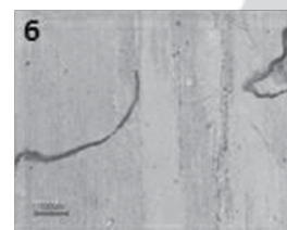
ภาพที่ 4 รอยตำหนิบนผิวขวดแก้วที่นำกลับมาใช้ใหม่ในรูปที่ 3
