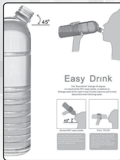
ภาพที่ 3 การออกแบบปากขวดน้ำดื่มให้เอียงทำมุมประมาณ 45 องศา เพื่อให้สะดวกแก่การบริโภค [3]
