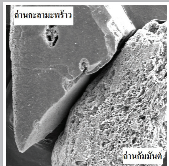
ภาพที่ 1 การเปรียบเทียบลักษณะโครงสร้างถ่านกะลามะพร้าว กับถ่านกัมมันต์
