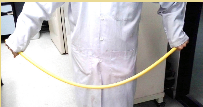
ภาพที่ 3 แสดงท่อขณะรับแรงดัด
