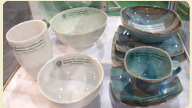
เคลือบที่มีสมบัติที่ยังเคลือบที่เรียบและสามารถทนไฟได้ถึง 1200 องศาเซลเซียส
