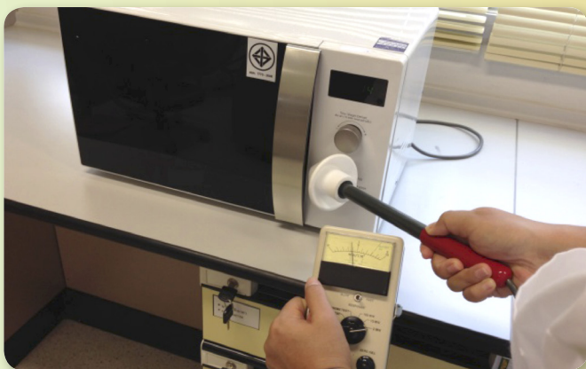
ภาพที่ 3 วิธีการตรวจสอบการรั่วไหลของคลื่นไมโครเวฟ
