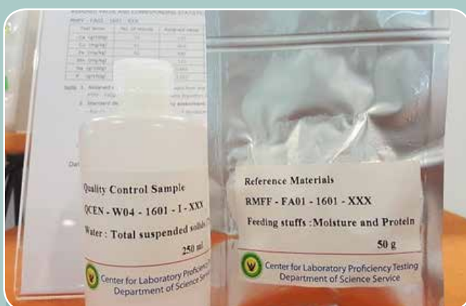
ภาพที่ 4 แสดงตัวอย่างวัสดุอ้างอิงและตัวอย่างควบคุมภายใน
