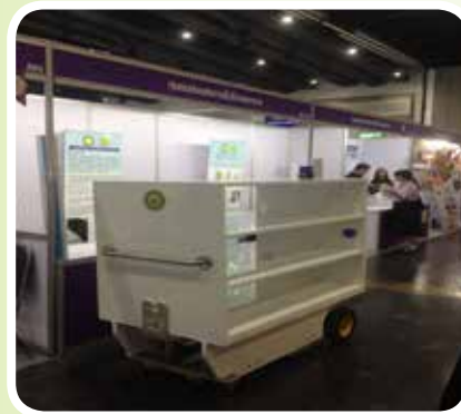
รูปแสดงผลิตภัณฑ์รถขนส่งยาหุ่นยนต์เบาบายแสนสะอาด ซึ่งทำจากวัสดุคอมโพสิตน้ำหนักเบา
