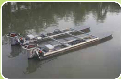
รูปแสดงเรือลาดตระเวนแบบสองท่อนควบคุมระยะไกล เพื่อใช้ช่วยตรวจรับวัตถุต้องสงสัยด้วยภาพ
