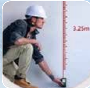
ภาพที่2 การใช้งานเครื่องวัดระยะเลเซอร์ (Laser distance meter)
