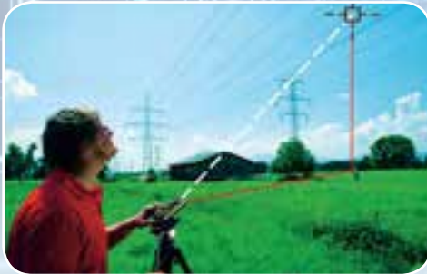
ภาพที่2 การใช้งานเครื่องวัดระยะเลเซอร์ (Laser distance meter)
