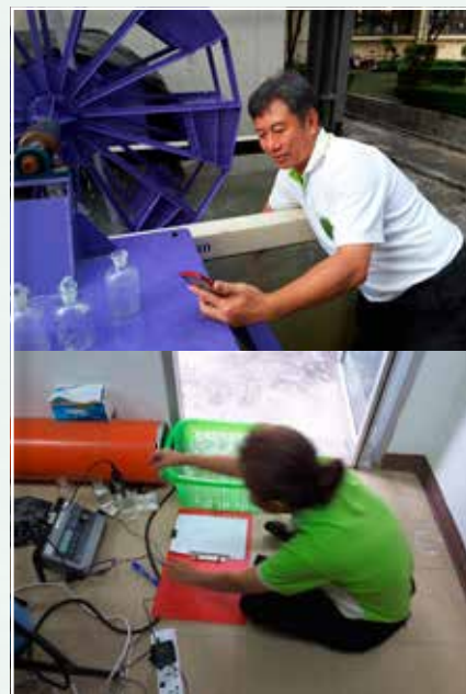
รูปขณะทำการทดสอบโดยสุ่มเก็บตัวอย่างน้ำในแท็งก์น้ำ และวัดค่า DO ด้วย DO Meter
