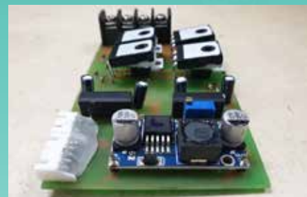
รูปที่ 2: วงจรไฟฟ้าระบบขับเคลื่อนของหุ่นยนต์ภาคสนามที่ นอ. พัฒนาขึ้น
