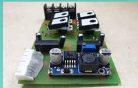
รูปที่ 2: วงจรไฟฟ้าระบบขับเคลื่อนของหุ่นยนต์ภาคสนามที่ นอ. พัฒนารัฐ
