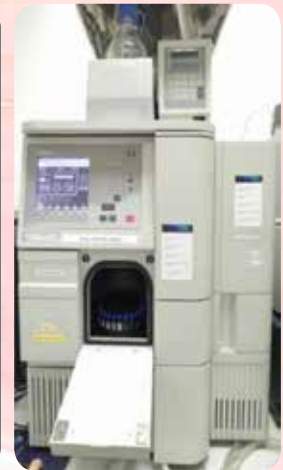
• ภาพแสดงการหาปริมาณสารพิษอะฟลาทอกซิน เอ็ม1 ในตัวอย่างนม ด้วยเครื่อง High-performance liquid chromatography
