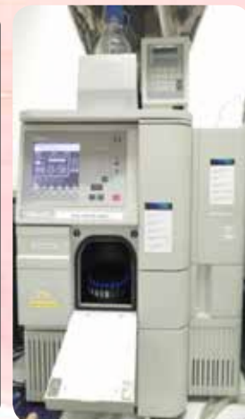
• ภาพแสดงการหาปริมาณสารพิษอะฟลาทอกซิน เอ็ม1 ในตัวอย่างนม ด้วยเครื่อง High-performance liquid chromatography
