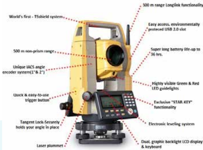
รูปที่ 2 โครงสร้างและหลักการการทำงานทั่วไปของกล้องสำรวจ
