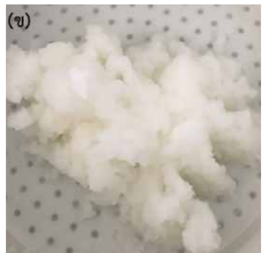
รูปที่ 1 ภาพถ่าย=ชานอ้อย (ก) และภาพถ่ายเซลลูโลสที่มาจากชานอ้อยหลังผ่านการปรับปรุงสภาพ (ข)
