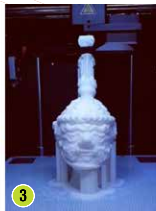
3 นำไฟล์ .gcode ที่ได้ ป้อนเข้าไปยังเครื่องพิมพ์สามมิติ และสั่งพิมพ์
