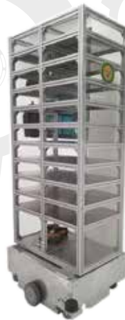
หุ่นยนต์เคลื่อนที่สำหรับงานขนส่ง และโลจิสติกส์ในโรงพยาบาล
