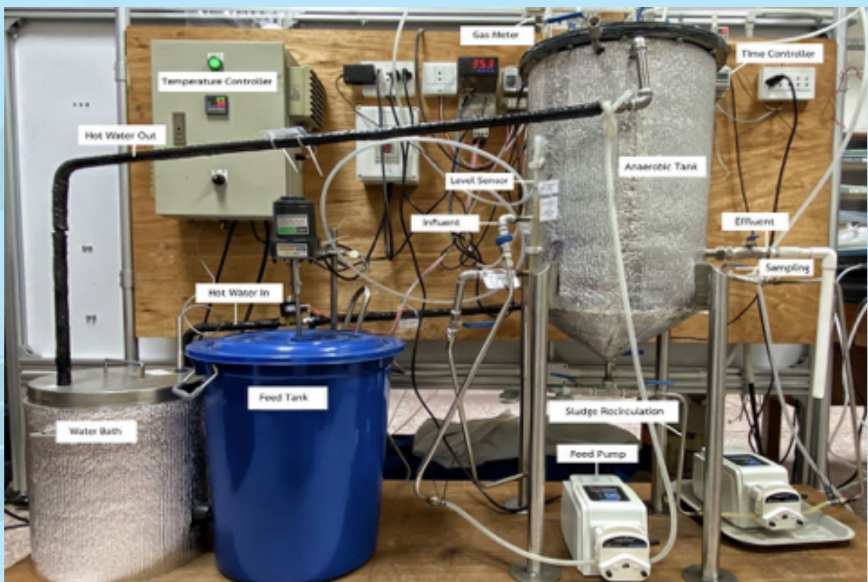
รูปที่ 1 ระบบบำบัดน้ำเสีย (ระดับห้องปฏิบัติการ) จากการแปรรูปมะพร้าวสำหรับวิสาหกิจชุมชนโดยการย่อยสลายแบบไม่ใช้ออกซิเจน
