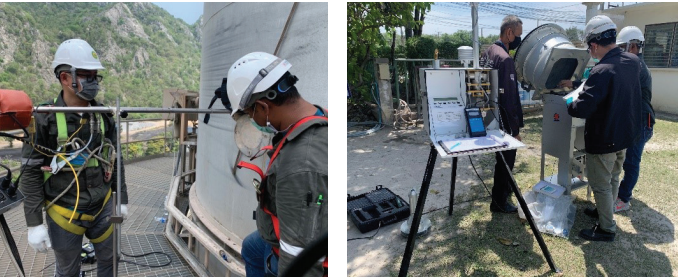
ภาพเก็บตัวอย่างฝุ่นละออง PM2.5 ในปล่องปล่อยสู่อากาศ รูปที่ 3 เก็บ ตัวอย่างฝุ่นละออง PM2.5 และ PM10 ในบรรยากาศ
