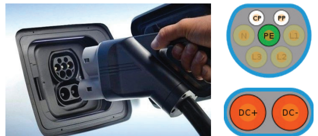
รูปที่ 6 เต้าเสียบและเต้ารับไฟฟ้ากระแสตรง แบบ CCS Combo 2
