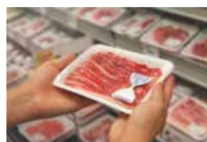
รูปที่ 8 แสดงบรรจุภัณฑ์ที่มีการใช้เซ็นเซอร์บอกความสดของอาหาร (ที่มา http://www.to-genkyo.com )
