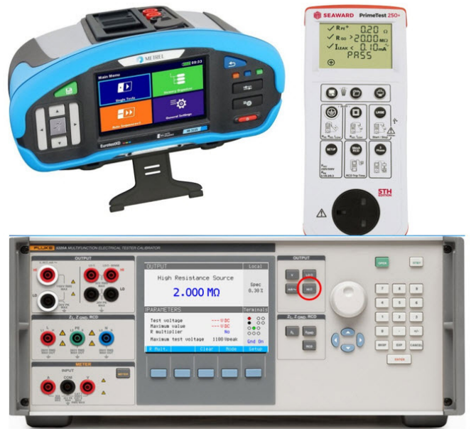
รูปที่ 3 เครื่องมือวัดและทดสอบระบบไฟฟ้าและเครื่องสอบเทียบเครื่องมือวัดและทดสอบระบบไฟฟ้า
