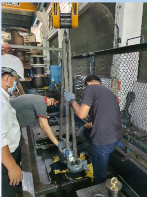
การสอบเทียบเครื่องดัดทดสอบลวดสลิง
