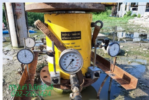
การทดสอบความแข็งแรงของเสาเข็มโดยใช้กระบอกลไฮดรอลิก
