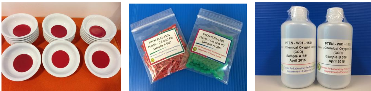
ภาพที่ 1 ตัวอย่างกิจกรรมทดสอบความชำนาญ : (ซ้าย) ภาชนะเซรามิก (กลาง) พลาสติก (ขวา) สารละลายวิเคราะห์ COD
